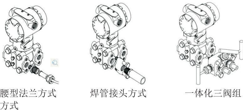
图2-4单晶硅式变送器引压图
